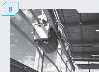
Система подачі бетону
