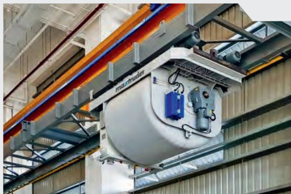
Система для подачи бетона
