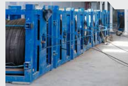
Składowanie i rozwijanie drutu sprężającego
