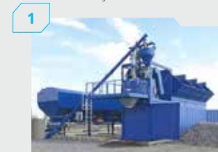
Instalacja mieszania betonu
