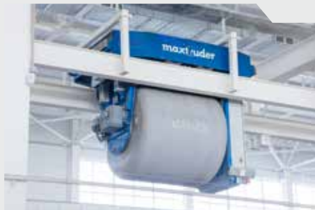
System transportu betonu
