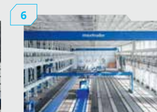
Stropowa suwnica pomostowa
