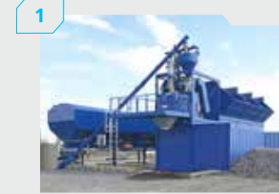
Beton karıştırma tesisi
