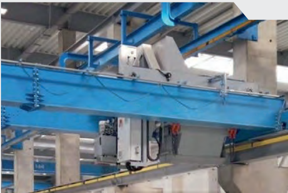
Distributeur de béton
