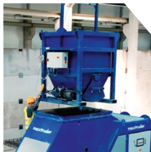
Benne de transport de béton
