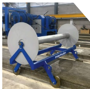
Устройство для укладки плёнки
