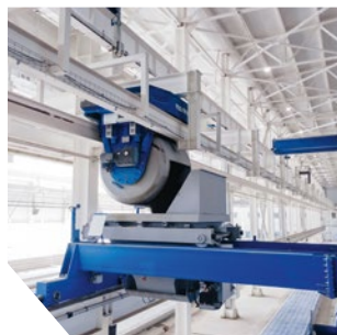
Система транспортировки бетона
