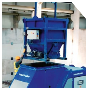
Ковш для транспортировки бетона
